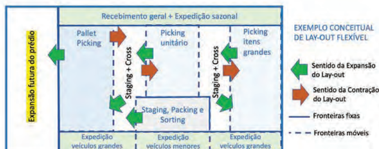
Figura 2 – Conceito de um layout de CD multiserviço com flexibilidade para se adaptar a oscilações de demanda
